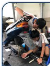
機車後輪鼓式剎車拆裝
